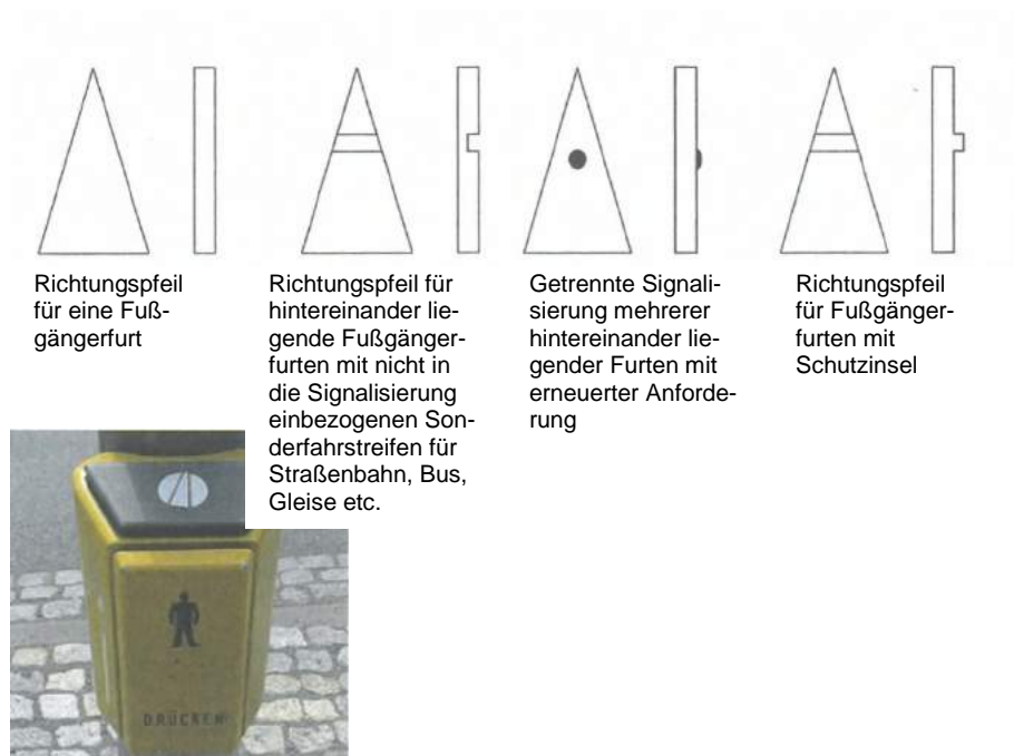
Abb. 5.3: Akustische Signalgeber mit ergänzenden taktilen Informationen 14
