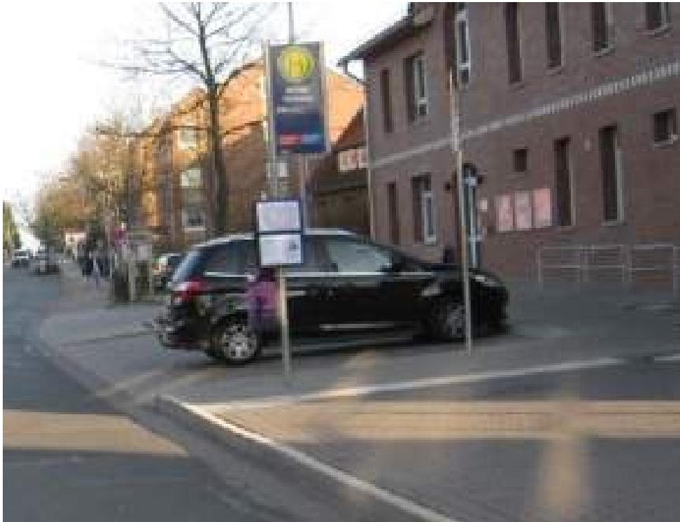
Abb. 5.16: OT Rethen: Bushaltestelle mit Buskapsteinen und taktilem Leitsystem
