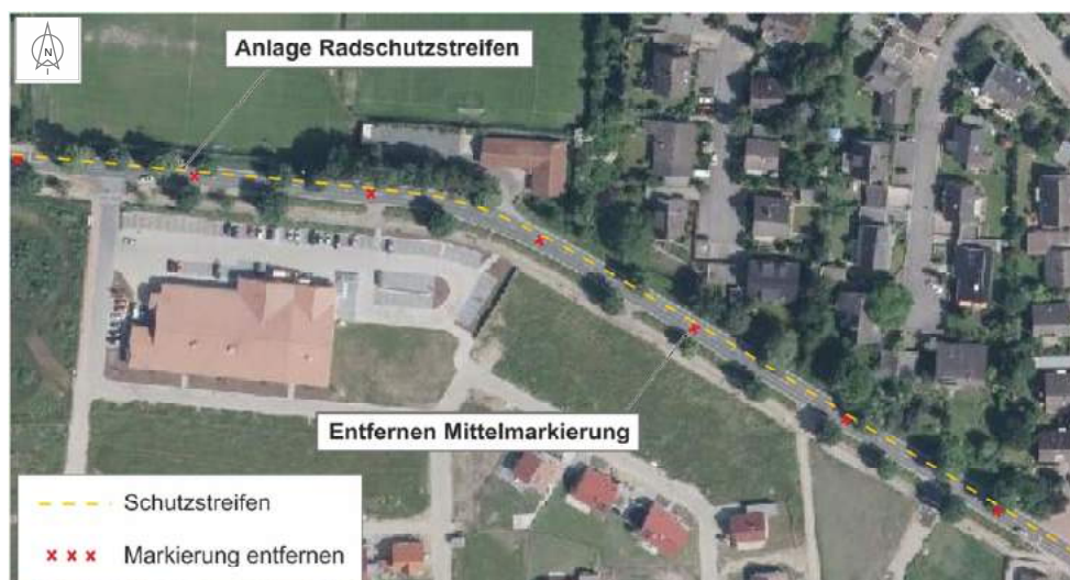
Abb. 7.9: Maßnahmenvorschlag „Strecke 14“: Gleidinger Straße (Ingeln-Oesselse) - Anlage Schutzstreifen
